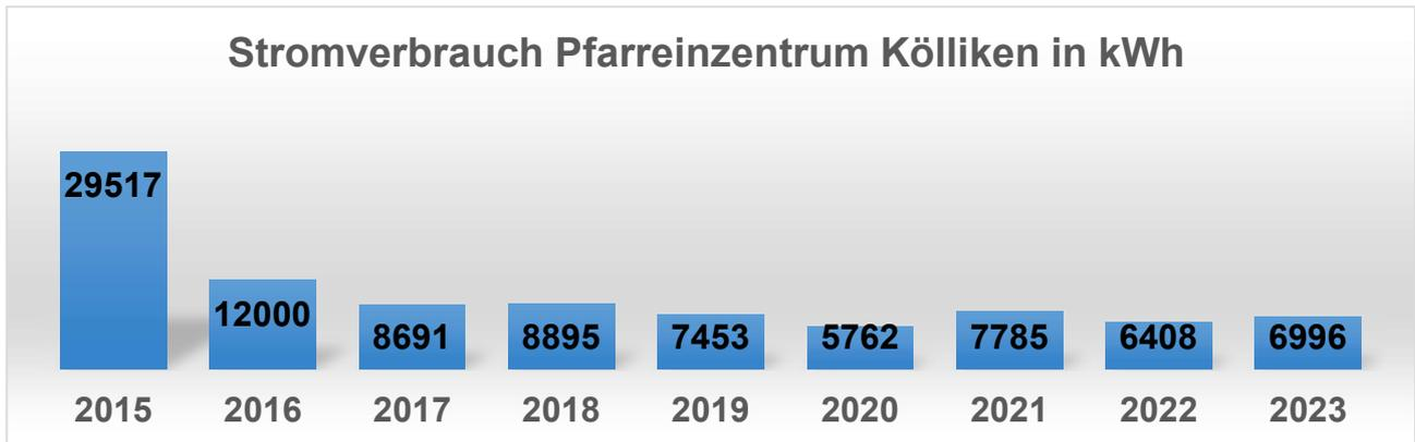
In **Kölliken** ist der Stromverbrauch nach der Sanierung 2016 / 2017 um rund 40% gesunken, trotz höherem Standard. Ein guter Teil des Stromverbrauchs wird über die Solaranlage selbst produziert. Solarstromernte und Eigenverbrauch siehe Diagramm unter Kapitel 5.3.
