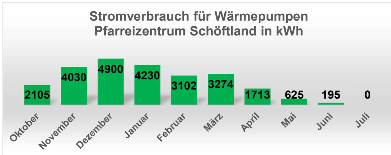
Das **Pfarreizentrum/die Kirche Schöffland** und das **Pfarrhaus** mit Pfarramt und Wohnung werden ab Oktober 2023 neu mit drei Luft-Wasser-Wärmepumpen geheizt. Die neuen Wärmepumpen produzieren aus einer Kilowattstunde Strom zirka drei Kilowattstunden Wärmeenergie.
